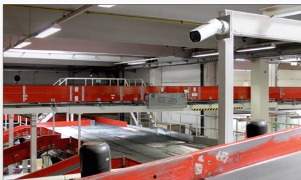
Videodokumentationssystem an einer Transportbandstrecke im DPD-Depot Heilbronn
